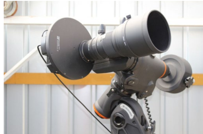
Ďalekohľad CDK20 (0,5 m) na montáži Paramount ME v prístrešku s odsuvnou strechou. Teleobjektív Sigma 2.8/300 so CCD kamerou Atik 383L+
