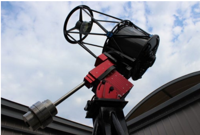
Ďalekohľad CDK20 (0,5 m) na montáži Paramount ME v prístrešku s odsuvnou strechou. Teleobjektív Sigma 2.8/300 so CCD kamerou Atik 383L+
