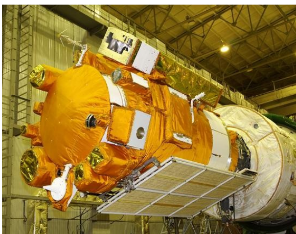
Obr. 1: Prístroje TESIS družice KORONAS-PHOTON po skompletovaní (vľavo) a schéma dvojčiek ďalekohľadov FET tohto prístroja použitých projektom pre testovacie pozorovanie (vpravo).
