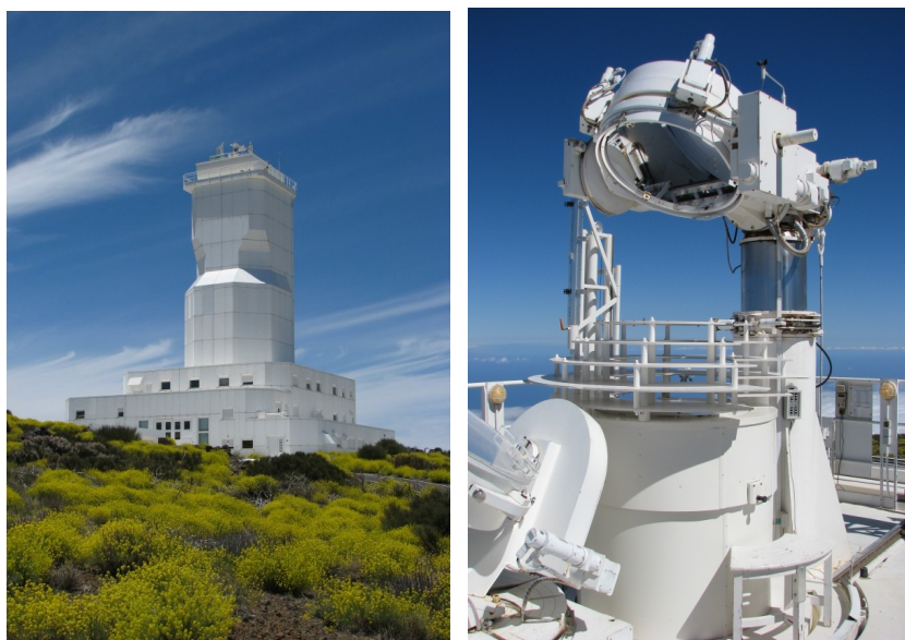
Obr. 1: Vákuový vežový ďalekohľad VTT – Observatorio del Teide (ostrov Tenerife, Španielsko): vľavo – celkový pohľad na vežovú budovu ďalekohľadu, vpravo – detail coelostatu samotného ďalekohľadu spolu so vstupným oknom vákuovaného nepohyblivého tubusu ďalekohľadu (foto: A. Kučera).
