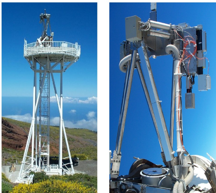
Obr. 1: Holandský otvorený ďalekohľad – Observatorio del Roque de los Muchachos (ostrov La Palma, Španielsko): vľavo – celkový pohľad na vežovú konštrukciu nesúcu samotný ďalekohľad, vpravo – detail samotného ďalekohľadu s hlavným zrkadlom a detekčným systémom v Newtonovom ohnisku.
